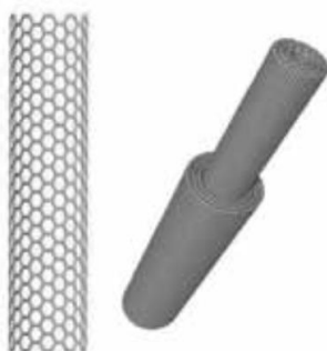
Rys. 7. Budowa nanorurek węglowych: po lewej jednowarstwowych (SWNT) , po prawej wielowarstwowych (MWNT) (www.zs9elektronik.pl).
