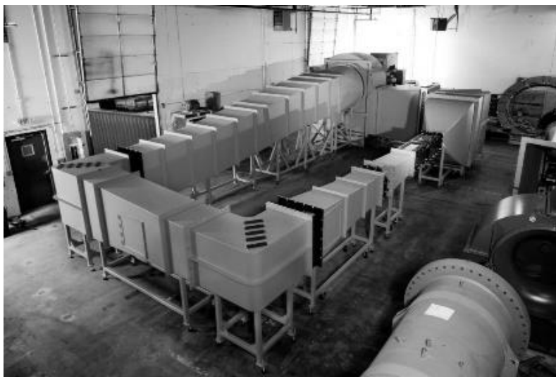
Rys. 2. Tunel o obiegu zamkniętym (aerolab.com).
