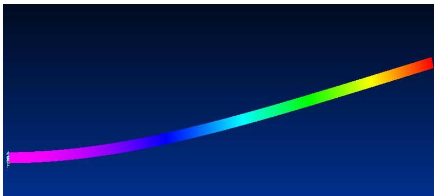
Rys.2. Pierwsza postać drgań własnych utwierdzonej belki.
