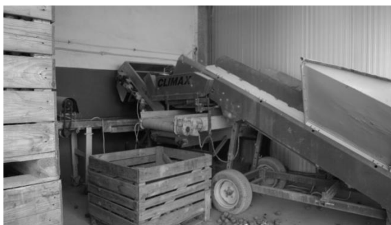
Rys.10. Wejście produktów na linię produkcyjną i pierwsze sortowanie.
