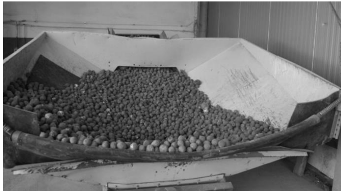
Rys.11. Kosz przyjęciowy firmy Climax na produkty, które przeznaczone są do mycia i sortowania.
