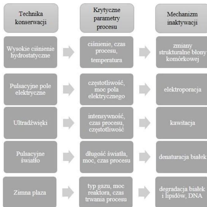
Rys. 3. Krytyczne parametry procesu i mechanizm działania na komórki drobnoustrojów wybranych nietermicznych metod konserwowania żywności. Na podstawie Morales de la Pena i in. 2018.
