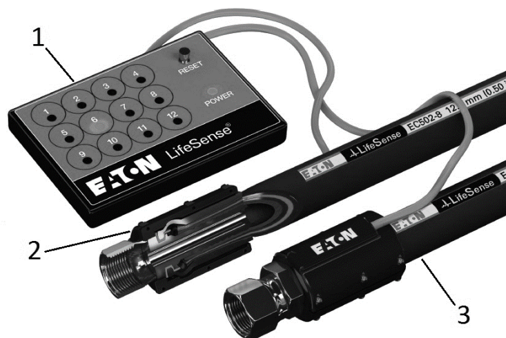
Rys. 3. System LifeSense firmy Eaton; 1 – jednostka diagnozująca, 2 – czujnik, 3 – przewód hydrauliczny (Eaton 2015).
