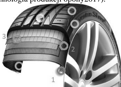
Rys. 1 Części składowe opony samochodowej z zaznaczonymi elementami ferromagnetycznymi 1 – drutówka, 2 - osnova, 3 – opasanie (Hankook tire, konstrukcja opon2017).
