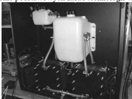
Rys. 3. Stanowisko pokazowo-dydaktyczne ogniwa paliwowego - wytwornica wodoru (Instrukcja obsługi stanowiska do wytwarzania wodoru).
