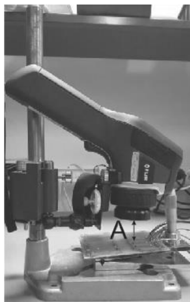
Rys. 5. Stanowisko pomiarowe z widoczną kamerą, dodatkowym obiektywem, płytką PCB z obserwowanymi diodami oraz odległością pomiędzy diodami i obiektywem ( A \approx 23 mm)
