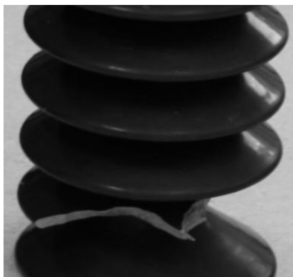
Rys.3. Przykład porcelanowego izolatora długopniowego (typ LP 75/14/860) z ukruszonym kawałkiem dysku.
