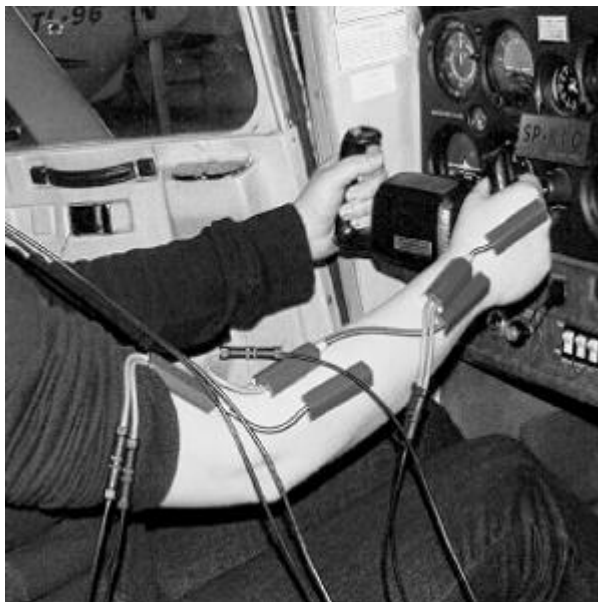
Rys.3. Przykładowe rozmieszczenie goniometrów na kończynie piersiowej badanej osoby (Merkisz i in. 2012).
