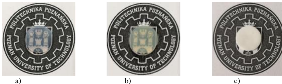
Rys. 3. Stopień separacji faz dla jonożeli o stopniu zamglenia: a) H=25%, b) H=30%, c) H=97%.
