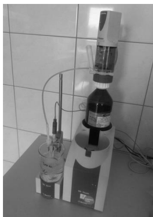
Rys. 3. Przyrząd do automatycznego miareczkowania potencjometrycznego Titrando 905.
