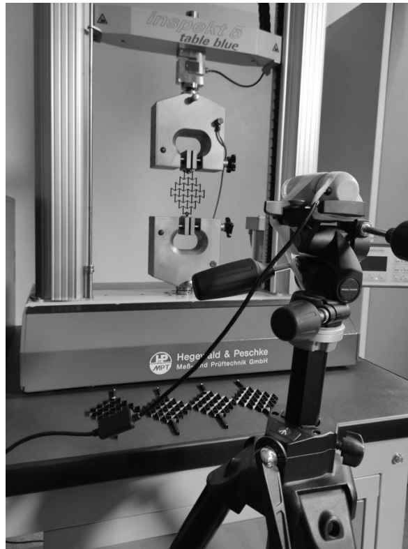
Rys. 7. Stanowisko do badań struktur auksetycznych
