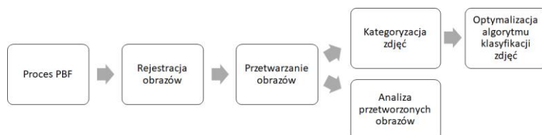
Rys. 12. Wykorzystanie przetwarzania obrazów i wizji komputerowej w procesie PBF.
