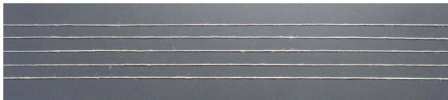
Rys. 1. Jednokierunkowa tkanina z przędz lnianych i przędze pobrane z tkaniny.
