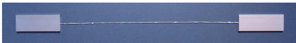
Rys. 2. Próbką w postaci przędzy lnianej zaimpregnowanej żywicą epoksydową.
