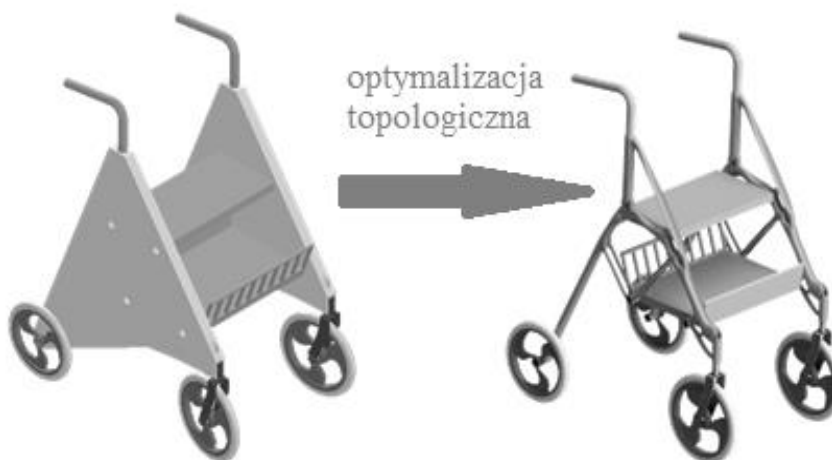
Rys. 8. Podpórka czterokołowa zoptymalizowana topologicznie .
