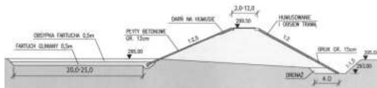
Rys.2. Przekrój poprzeczny zapory czołowej Czaniec (Bałus 2007).
