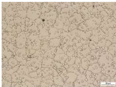
Rys. 10. Mikrostruktura stali SW7M po wyżarzaniu pełnym. Widoczny ferryt z cemenytem w postaci kulkowej oraz innych węglików. Traw. Nital + Klemm, LM.
