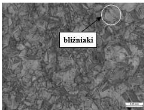
Rys. 7. Mikrostruktura mosiądzu po odkształceniu plastycznym, przekrój wzdłużny, traw. Mi17Cu+Klemm, LM.
