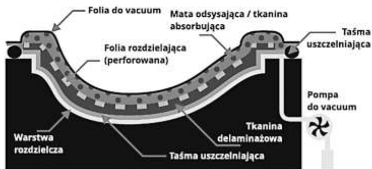
Rys. 4. Schemat metody formowania próżniowego (CompoTec – technologie kompozytowe 2018)
