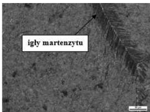
Rys. 14. Mikrostruktura brązu aluminiowego po ulepszeniu cieplnym, traw. Mi17Cu, LM.
