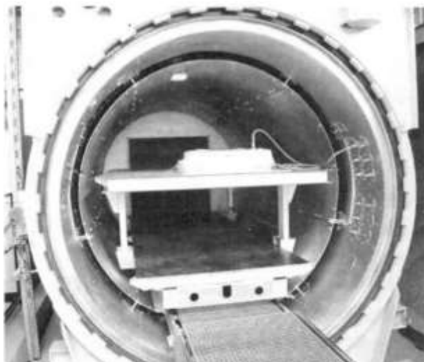
Rys. 6. Widok rzeczywisty komory autoklawowej wypełnionej formami z preimpregnatami (Boczkowska i Krześciński 2016).
