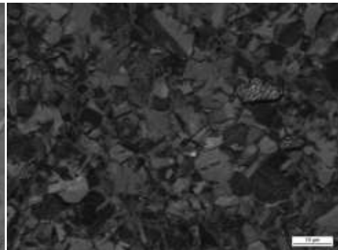
Rys. 7. Mikrostruktura stali typu TWIP, materiał rodziny, traw. elektrolitycznie+ Klemm.
