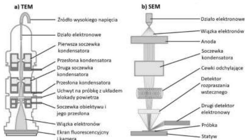
Rys. 3. Schemat: a) transmisyjnego mikroskopu elektronowego (TEM), b) skaningowego mikroskopu elektronowego (SEM).
