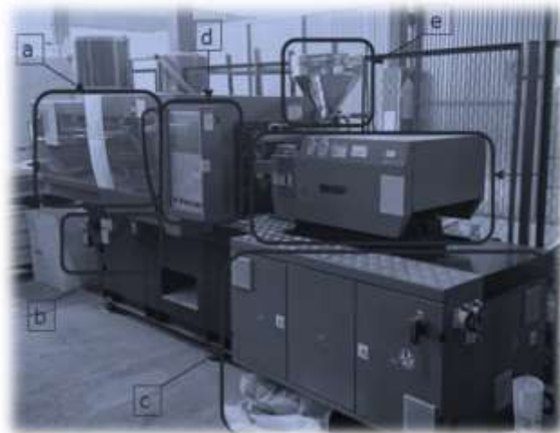
Rys. 3. Wtryskarka Borche BS60 z wyróżnionymi elementami składowymi: a - przestrzeń robocza formy z układem zamykania, b - układ smarowania, c - układ zasilania, d - układ sterowania (panel sterowania), e - lej zasypowy, f - agregat wtryskowy
