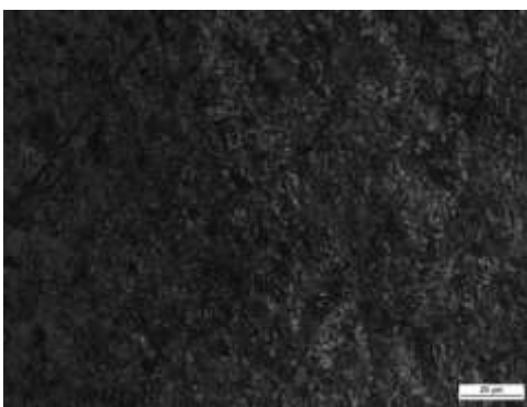
Rys. 10. Mikrostruktura stali typu TWIP, materiał odkształcony, traw. elektrolitycznie+ Klemm.
