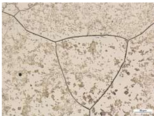
Rys. 12. Mikrostruktura stali SW7M po hartowaniu nad temperatury A_{cm} . Widoczny martenzyt na tle austenitu nieprzemienionego. Traw. Nital + Klemm, LM.
