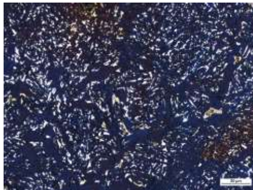
Rys. 9. Mikrostruktura stali SW7M po wyżarzaniu normalizującym. Widoczny ferryt z licznymi niewielkimi ziarnami martenzytu i austenitu szczątkowego. Traw. Nital + Klemm, LM.
