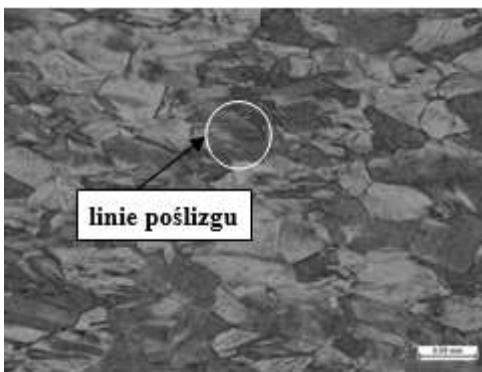
Rys. 9. Mikrostruktura mosiądzu po odkształceniu plastycznym, przekrój wzdłużny, traw. Mi17Cu+Klemm, LM.
