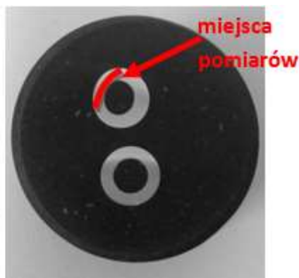
Rys. 3. Rozmieszczenie pomiarów twardości na próbce ze stali X5CrNi18-10, odkształconej plastycznie
