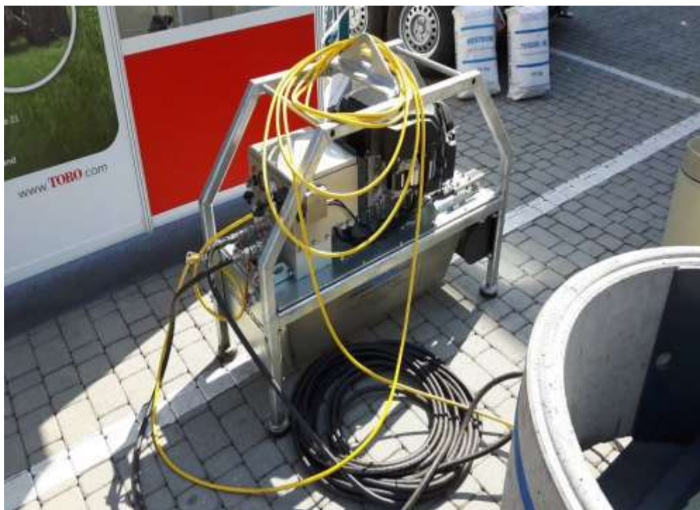
Rys. 4. Maszyna do odnowy sieci kanalizacyjnych w technologii krakingu statycznego (studniarska).
