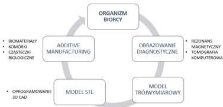
Rys. 1 Schematyczne przedstawienie głównych etapów wymaganych do wytworzenia wyrobów wykorzystywanych w inżynierii tkankowej z wykorzystaniem techniki Additive Manufacturing. Opracowano na podstawie: (Piaia i in. 2018).
